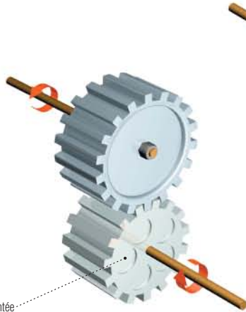
engrenage M cylindrique à denture F droite spur gear rueda F cilíndrica de dientes M rectos Stirnradgetriebe N ingranaggio M cilindrico a ruote F dentate
